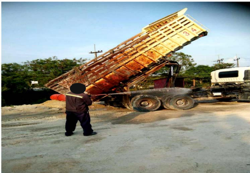
รูปที่ 6 สถานีฉีดล้างล้อก่อนออกนอกเหมือง
